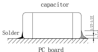
②. 过长的焊接时间会影响端头的可焊性, 焊接时间尽可能保持与推荐时间一致。
